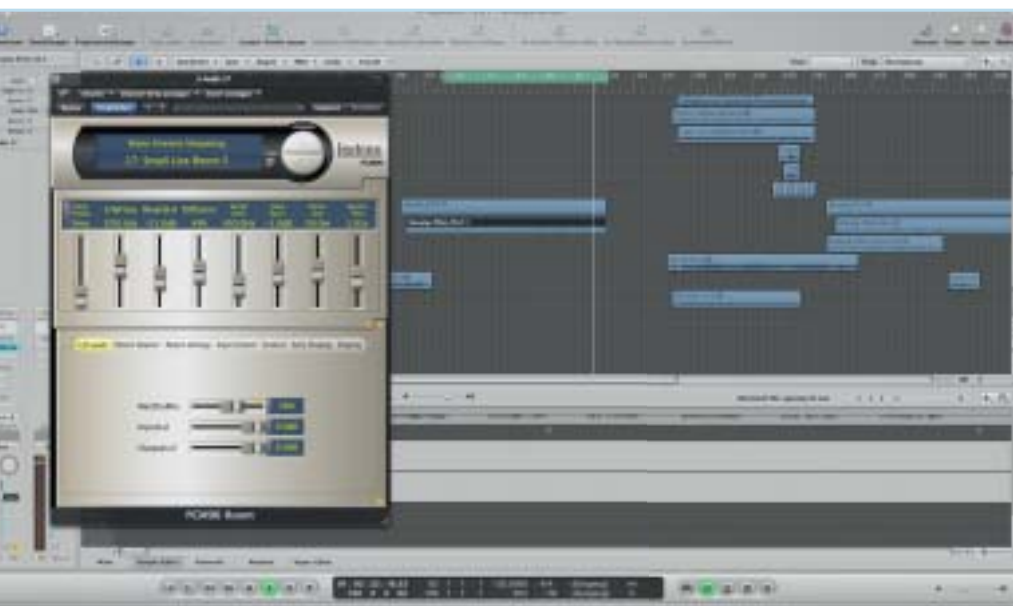
Der PCM 96 als DSP-Plug-in in einem Logic-Projekt. Die Bedienoberfläche der Plug-in-Software (bisher nur für Macs) ist sehr übersichtlich und einfach zu bedienen. Im Plug-in-Betrieb sind allerdings die raffinierten System-Presets, die die vier virtuellen Prozessor-Maschinen voll ausreizen, nicht verfügbar.
