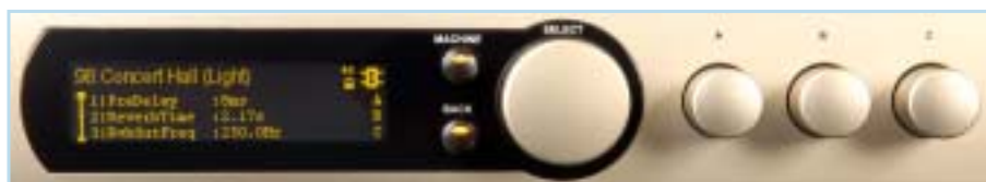
Neben dem sehr gut ablesbaren LCD-Display sind die Hauptbedienelemente angeordnet: Mit dem großen Dreh- und Druckgeber wird das Gerät konfiguriert, die verschiedenen Menüebenen aufgerufen und die Presets ausgewählt. Die kleinen A-B-C-Regler dienen der eigentlichen Einstellarbeit. Hierüber werden auch die insgesamt 60 Parameter der Hall- und Effekt-Algorithmen eingestellt.
