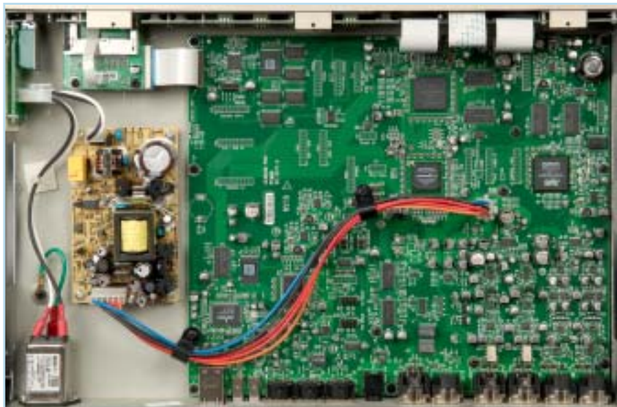
Im Inneren des PCM 96 werkelt ein mit 300 MHz getakteter ADSP-TS101S TigerSHARC-Prozessor von Analog Devices (Mitte rechts) unterstützt von mehreren FPGAs.
