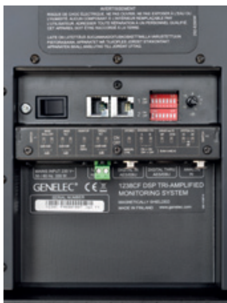
Ein Blick auf die Rückseite des 1238CF gibt einen Eindruck von den manuellen Eingriffsmöglichkeiten auf der digitalen Ebene. Oben in der Mitte die Ports für das Steuerungsnetzwerk. Diese sind nicht Ethernet-kompatibel
